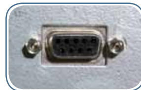
Connessione RS232 RS232 connection Conexión RS232 RS232 Anschluß Выход для информационной связи с компьютером по интерфейсу RS232 Connexion RS232
